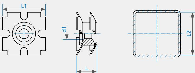
\* Per la definizione del prodotto è consigliabile effettuare prove di montaggio. Evitare trattamenti termici, galvanici o altre operazioni di riscaldamento successive all'inserimento del Crown-Nut che possano compromettere le caratteristiche del prodotto.
