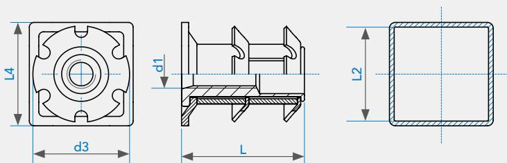
\* Per la definizione del prodotto è consigliabile effettuare prove di montaggio. Evitare trattamenti termici, galvanici o altre operazioni di riscaldamento successive all'inserimento del Crown-Nut che possano compromettere le caratteristiche del prodotto.
