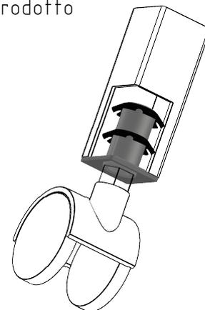
\*Per la definizione del prodotto è consigliabile effettuare prove di montaggio. Evitare trattamenti termici, galvanici o altre operazioni di riscaldamento successive all'inserimento del Crown-nut che possano compromettere le caratteristiche del prodotto.
